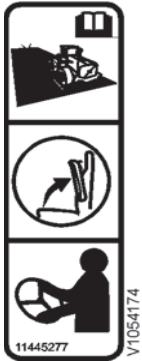
27 Gebruik joystickbesturing (CDC) op de openbare weg verboden – stuurwiel gebruiken.
